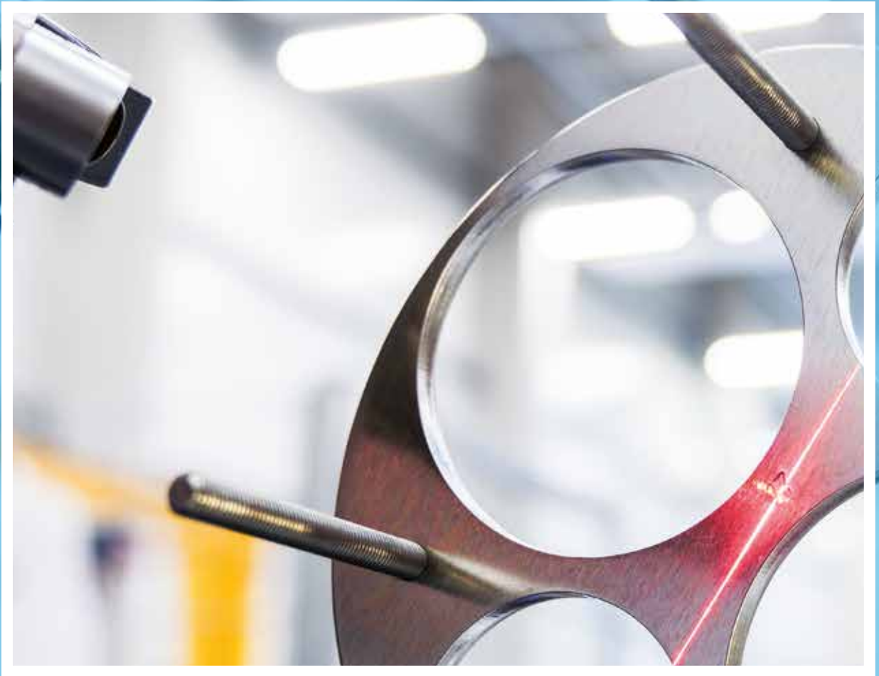
Contrôle final de la qualité de l'anneau du support
